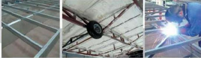
Chasis reforzado realizado en acero galvanizado tipo E-220+Z-275-NAC de gran resistencia a la intemperie y ambientes salinos. (fabricado según norma europea UNE-EN10305-5)
